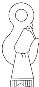
Kuva 1 – Kuvassa esitetään tilanne, jossa nostokoukku on liian kapea nostovyön leveyteen nähden.
