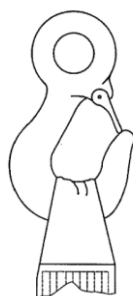
Bild 1- Bild som visar otillräckligt tillmötesgående av en bandögla på en krok med en för liten radie
