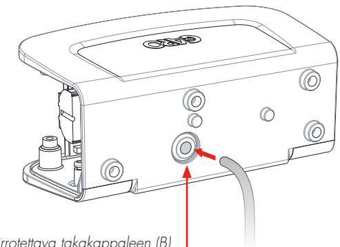
*Knockout-kappale on irrotettava takakappaleen (B) selkäpuolelta, ennen kuin kytken tä voidaan tehdä.*
