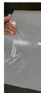
Den gjennomsiktige beskyttelsesfilmen på 4,0 mm takplater viser til den siden av platen som ikke er UV-beskyttet.
