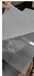
Valge kaitsekile 4,0 mm katusepaneelil näitab, et see on paneeli UV-vastase kaitsega külg.
