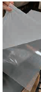
Takpanelernas vita skyddsfilm på 4,0 mm visar den UV-skyddade sidan av panelen.
