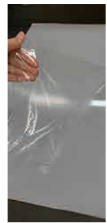
Läpinäkyvä suojakalvo 4,0 mm kattopaneeleissa osoittaa paneelin UV-suojaamattoman puolen.
