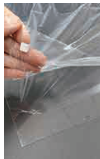
Läpinäkyvä suojakalvo 0,7 mm seinäpaneeleissa osoittaa paneelin UV-suojaamattoman puolen.
