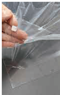
Vägghpanelernas genomskinliga skyddsfilm på 0,7 mm visar den UV-oskyddade sidan av panelen.
