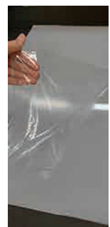
Läbipaistev kaitsekile 4,0 mm katusepaneelil näitab, et see on paneeli UV-vastase kaitseta külg.
