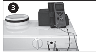
Mittaa jännite navoista – ja S, säädä esim. nopeus 1 potentiometrillä 1
