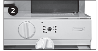
Nupin alla on säätö- ja mittausreiät
