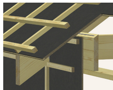
Seinän ja katon liitos, räystäälle jatkuvat yläpaarteet
