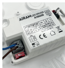
Pir-mallin säätö dip-kytkimellä.
