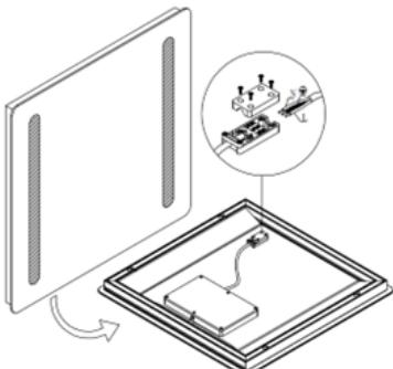
3. Ripusta valopeili seinälle kiinnitysruuvien varaan. Tarkista valopeilin toiminta virtakytkimestä.
