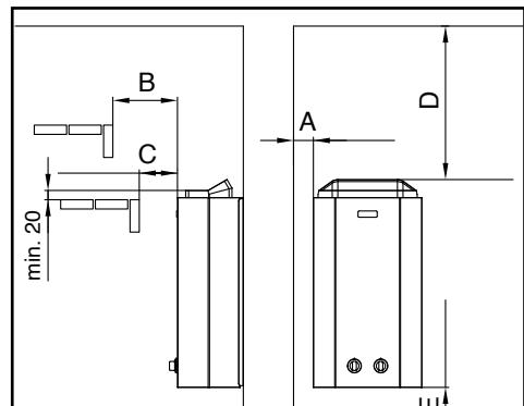
Bild 1. Skyddsavstånd till bastuaggregatet
