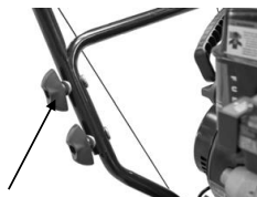
Knopp, bricka och bult Bild 1
