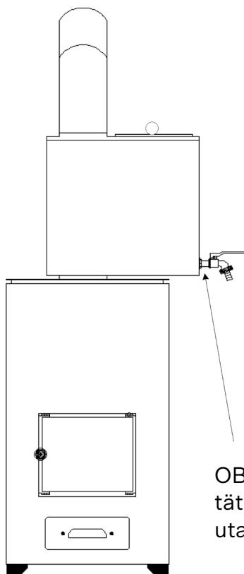
OBS! Vattenkranens tätning bör vara utanför tanken
