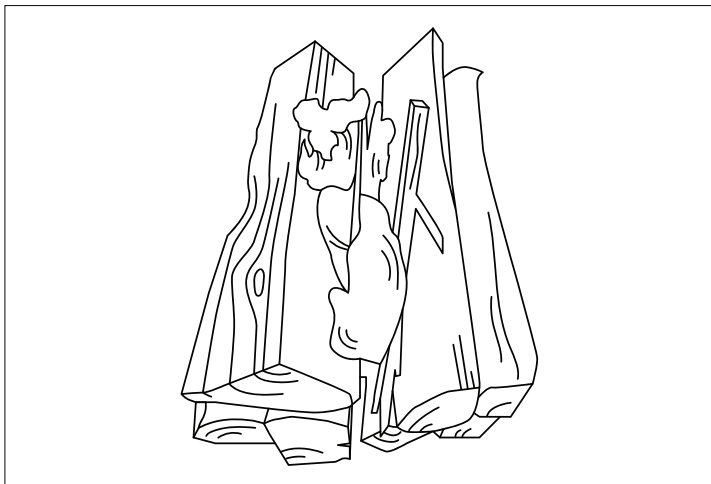
Figur 9. Rätt fyllning med ved.
