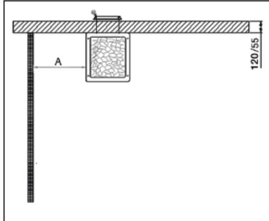
Размер «A» определяется, исходя из вида изоляции деревянной поверхности.
