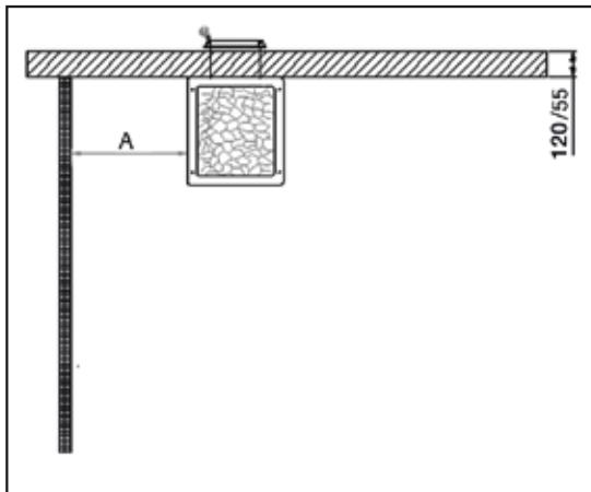
Mått A ska bestämmas efter skyddsmedoden som har använts för trätor.
