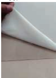
Den hvit beskyttelsesfilmen på 1,2 mm veggplater viser til den UV-beskyttede siden av platen.
