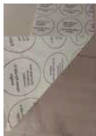
Takpanelernas vita skyddsfilm på 4,0 mm visar den UV-skyddade sidan av panelen.
