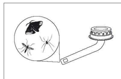
Det kan forhindre gassen i at nå frem til venturirøret og forårsage en gullig, røgfyldt flamme ved brænderen eller gøre det umuligt at tænde brænderen. Det kan endda resultere i en forbrænding af gassen uden for tilførselsrøret, hvilket kan medføre alvorlige skader på grillen.
