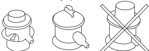
Lavtryksregulatorne på 30 mbar på billedet passer til en gasgrill, mens højtryksregulatoren til højre er beregnet til LPG-værktøj og må ikke bruges til en gasgrill. Den anvendte gasslange skal være en 10 mm LPG-slange, der er godkendt til brug i det relevante land. Længden må ikke overstige 1,2 m. Lavtryksregulatoren skal overholde standarden EN16436 eller EN16129 samt de nationale bestemmelser.
