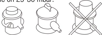
Kuvassa 29-30 mbar matalapainesäätimet, jotka ovat oikea valinta kaasugrillille sekä oikealla korkeapainesäädin, joka on tarkoitettu nestekaasutyökaluiille eikä sitä saa käyttää kaasugrillissä.
