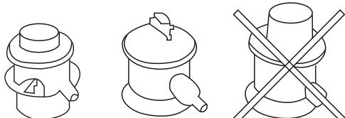
På bildet vises det to lavtrykksregulatorer 30 mbar, som er riktig valg til gassgrillen samt en høytrykksregulator som kun skal benyttes til gassverktøy. Bruk ikke denne til gassgriller.
