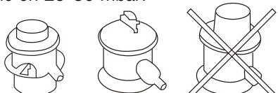
Kuvassa 29-30 mbar matalapainesäätimet, jotka ovat oikea valinta kaasugrillille sekä oikealla korkeapainesäädin, joka on tarkoitettu nestekaasutyökaluiille eikä sitä saa käyttää kaasugrillissä.
