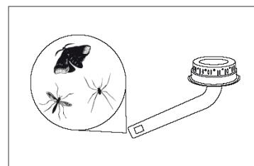
Det kan forhindre gassen i at nå frem til venturirøret og forårsage en gullig, røgfyldt flamme ved
