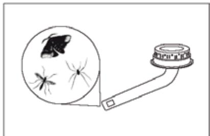
Ifall detta inträffar, stäng av gasventilerna till "OFF" läge och vänta tills grillen är sval. När grillen har svalnat, lösgör brännaren och rengör blandarröret med en borste eller piprensare. Montera tillbaka brännaren enligt råd och försäkra att blandarröret är rätt över ventilen med munstyckena enligt råden. Var noggrann med att blandarröret är korrekt påträdda på ventilen.
