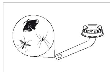
Det kan forhindre gassen i at nå frem til venturirøret og forårsage en gullig, røgfyldt flamme ved
