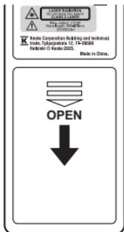
Aseta laitteeseen 2 kpl 1,5 V:n AAA-paristoa paristokotelon sisäpuolella olevien suuntakuvakkeiden mukaisesti. Kiinnitä kansi takaisin.
