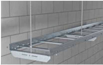
MAHU Keskikannake Ø13 reikä kierretangolle. Tikashylly kiinnitetään keskikannakkeeseen LKS 40 kiinnityskappaleella. Kaapelikuorma jaettava tasaisesti.
