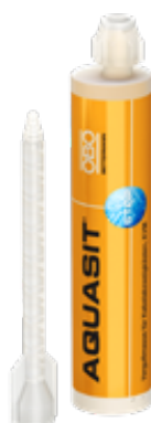
Kovettunut joustava geeli antaa vedenpitävän suojan – IP68. Geeli toimii myös johdinten vedonpoistimena. Sähkömittaukset voidaan tehdä geelin läpi – se tiivistyy itsestään.
