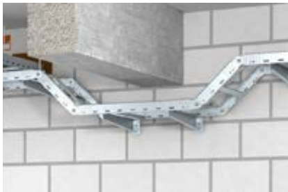
AW 30 Seinäkannake asennetaan seinään sopivilla ankkureilla. Tikashylly kiinnitetään kannakkeeseen LKS 40 kiinnityskappaleella.
