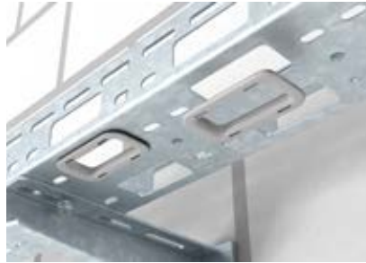
KSR 915 kaapelisuoja sopii pohjan aukkoihin ja KSR 910 sivun aukkoihin. Asennus tapahtuu painamalla kaapelisuoja aukkoon.
