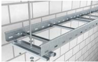
MAHL Matala keskikannake Ø13 reikä kierretangolle. Tikashylly kiinnitetään keskikannakkeeseen LKS 40 kiinnityskappaleella. Kaapelikuorma jaettava tasaisesti.
