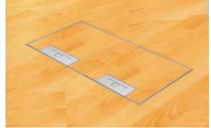
UKL2 500 KR 6x3 modulia min. Ø185mm onteloon Pintavalun aukkovaara 260x530mm
