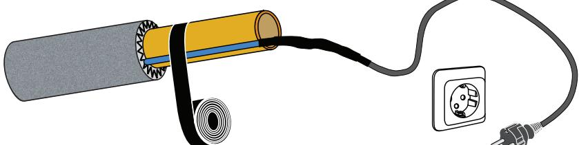
Plug'n Heat kaapelia käytetään putkien, vesimittarien ja muiden jäätymiselle alittiiden kohteiden sulanapitoon. Kaapeli on varustettu pistotulpalla, jolla kaapeli liitetään maadoitettuun pistorasiaan. Kiinteässä asennuksessa kaapeli asennetaan kaikkinapaisen käyttökytkimen tai termostaatin ohjaamaksi liitätäkaapelin vedonpoistolla varustettuna.
