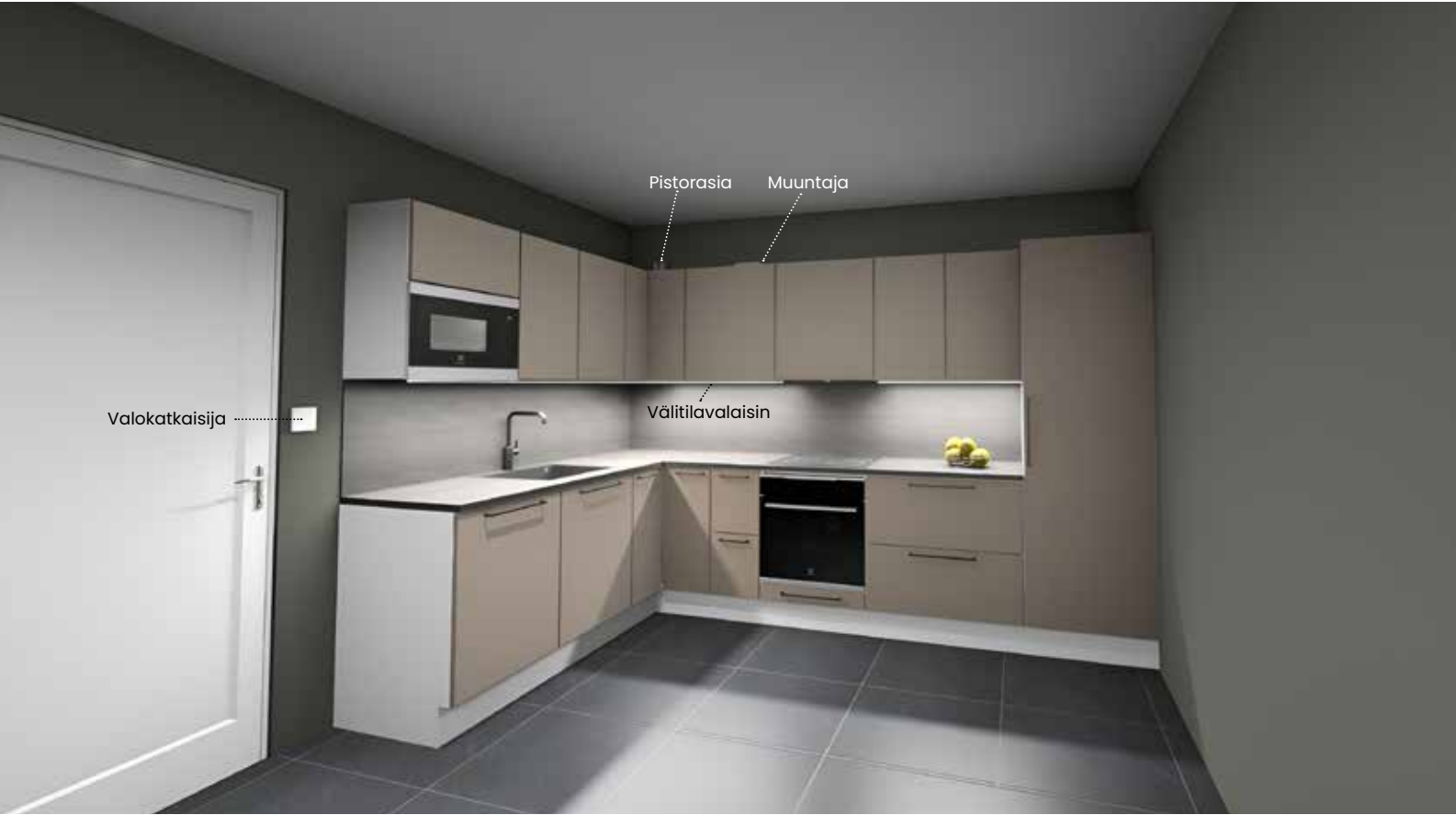
Kuvan esimerkissä 5000 mm valonauha on katkaistu ensin kulman vuoksi. Virtajohtot kulmasta ylös jakajamoduuliin. Liesituulettimen vuoksi valonauha joudutaan katkaisemaan uudelleen, joten joudutaan käyttämään lisäksi yhdysjohtoa 80494 tai virtajohtoa 80491.
