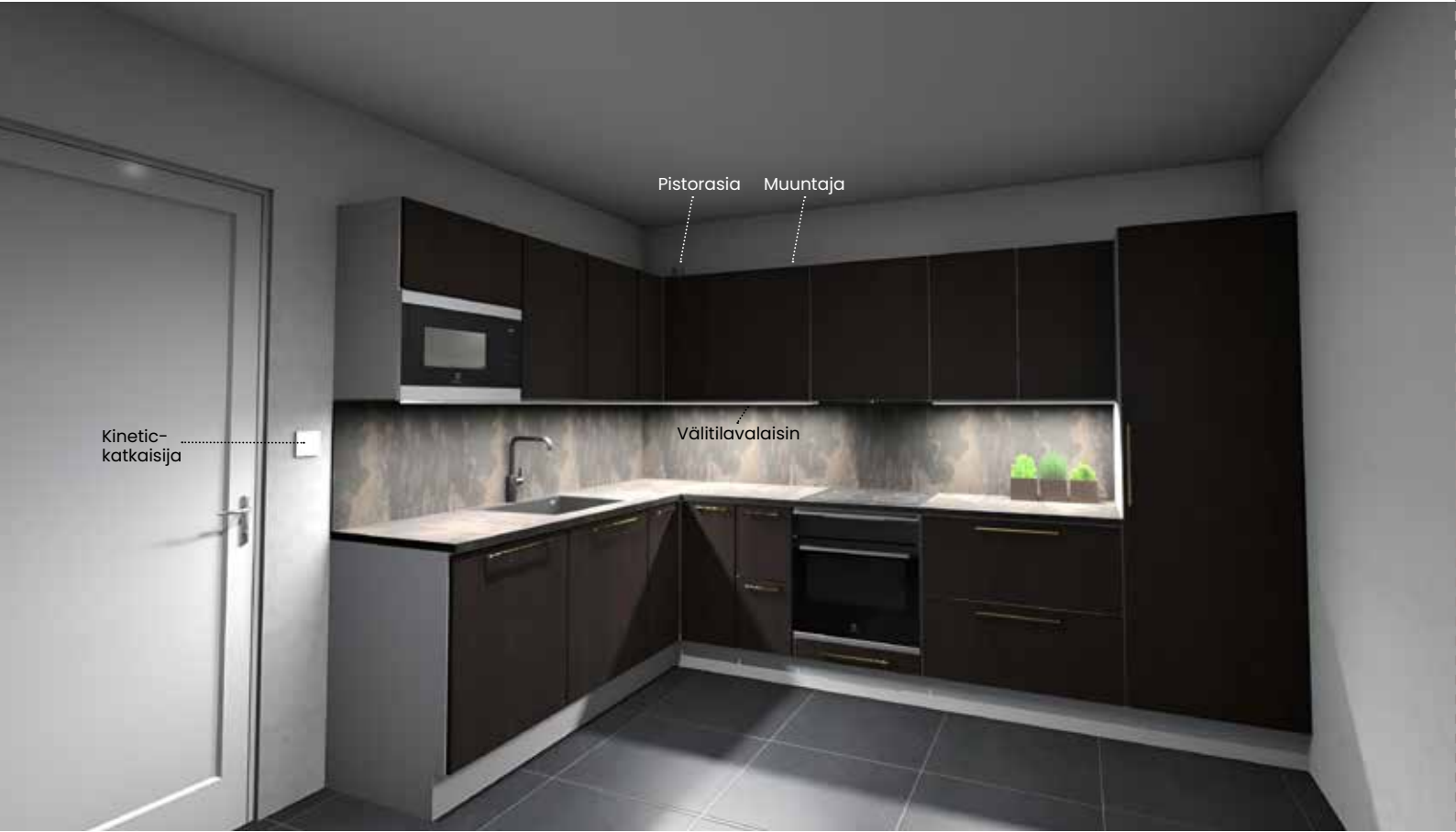
Kuvan esimerkissä 5000 mm valonauha on katkaistu ensin kulman vuoksi. Virtajohdot kulmasta ylös jakajamoduuliin. Liesituulettimen vuoksi valonauha joudutaan katkaisemaan uudelleen, joten joudutaan käyttämään lisäksi yhdysjohtoa 80494 tai virtajohtoa 80491.
