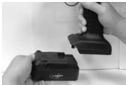
2. Drücken Sie den Batterietaster und entnehmen Sie den Akkusatz.
