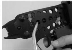
4. Geben Sie 1-2 Tropfen Schmierfett, Nähmaschinenöl oder Motoröl in das Wellengewinde und die Klemmbackennut des Werkzeugs (die Schmierpunkte sind durch Pfeile gekennzeichnet).
