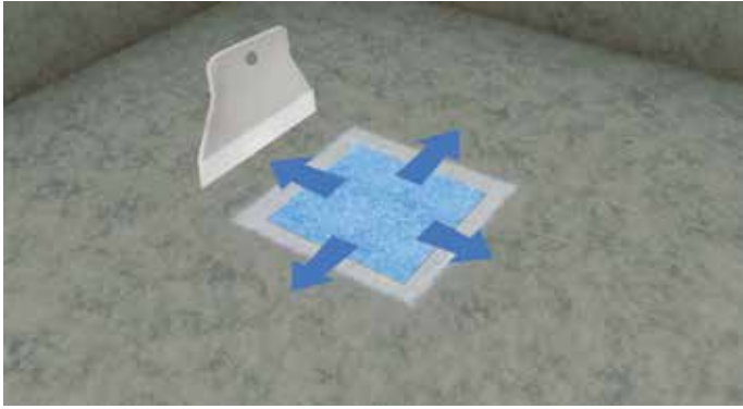
3. Poista suojakalvon loppu ja paina kappale huolellisesti kiinni siten, että kaikki ilma tai liika vedeneriste poistuu läpivientikappaleen alta (Huom! painaen kaivosta pois päin)
