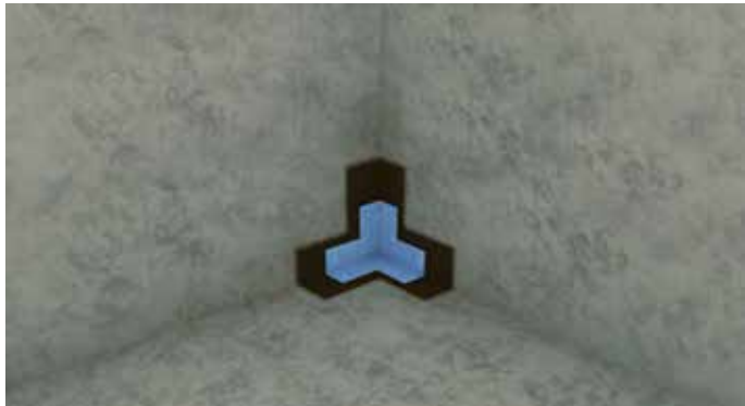
2. Paina WetStop PC/PC-e -nurkkakappale kiinni tuoreeseen vedeneristeeseen siten, että kaikki ilma poistuu kappaleen alta. Jos nurkka ei ole täysin suorassa ja nurkkakappaleeseen syntyy pussi, pyri ohjaamaan pussi tulevan limityksen alueelle ja tee sinne viilto. Muista, että vahvikekappaleiden tulee limittyä ehjänä vähintään 5 cm.
