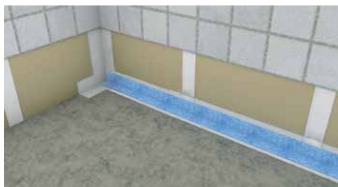
5. Paina nauha kiinni tuoreeseen vedeneristeeseen. Käytä SCHÖNOX iFIX -vedeneristeliimaa, jos kiinnität WetStop KL -nauhaa. Kaikissa tapauksissa tiivistys-/vahviketarvikkeiden tulee limittyä vähintään 5 cm päällekkäin.
