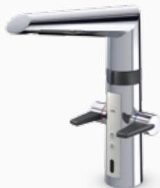
Oras nro. 2725F, LVI-nro 6219074 Älykäs keittiöhana, jossa kosketusvapaa toiminto ja astianpesukoneventtiili. Paristokäyttöinen (3 V)
