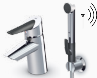
**Oras nro. 2713F, LVI-nro 6110081 Pesualtaan vipuhana, jossa älykäs Bidetta ja Easy Grip -vipu. Paristokäyttöinen (3 V)
